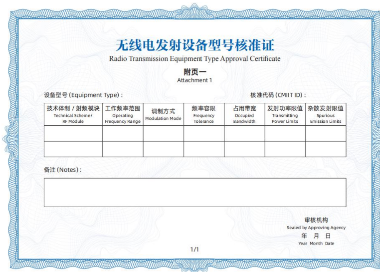
图 3-4 新版无线电发射设备型号核准证附页一（自 2023 年 12 月 1 日起实施）
